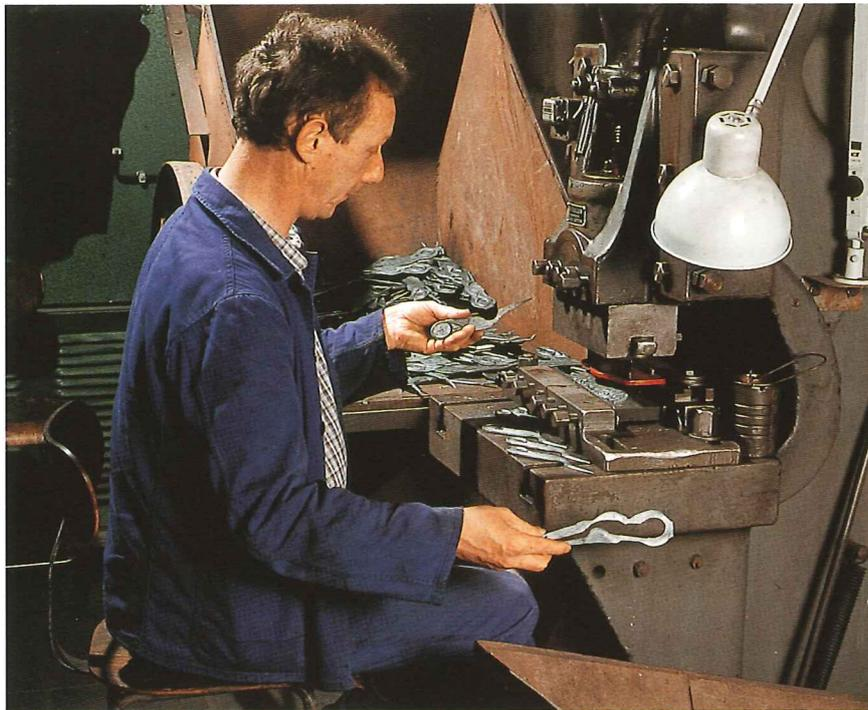
*Entgraten der geschmiedeten Werkstücke an der Exzenterpresse*
