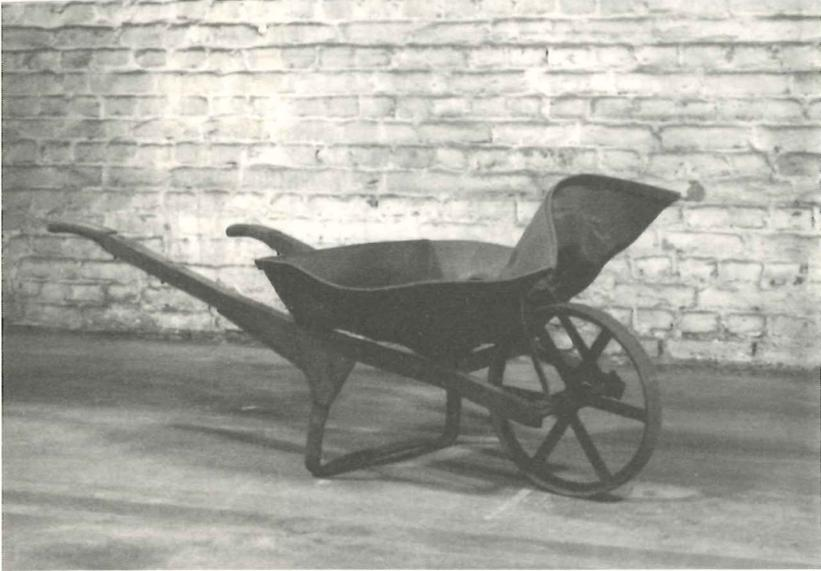
*Schubkarre aus einer Wuppertal-Cronenberger Gesenkschmiede. Die Karre wurde bis 1990 für den innerbetrieblichen Transport von frisch geschmiedeten Axt-Rohlingen verwendet und dabei durch das noch glühende Material verformt.*
