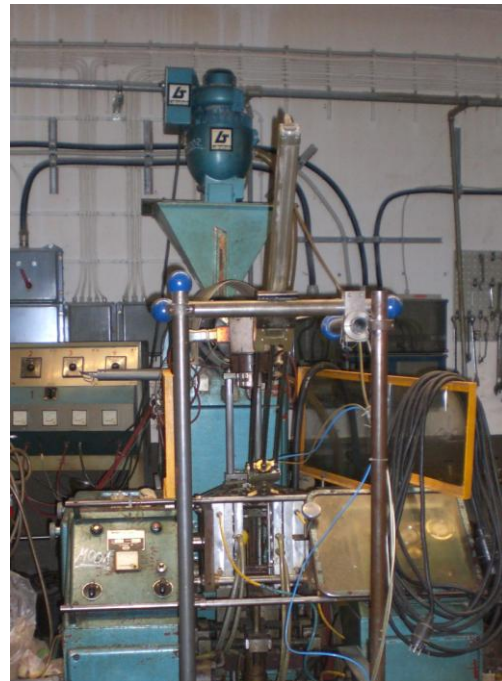
Kunststoff-Spritzgussmaschine, 1960er Jahre. Dieses Exponat steht für das Gießen als Fertigungsverfahren und die Substitution von Werkstoffen: Konsumgüter wurden früher aus Zink, heute aus Kunststoff hergestellt.
