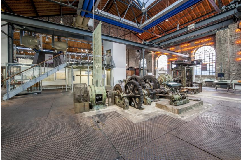
Vorstreckwalze der Zinkfabrik Altenberg, 1924/1960er Jahre. Die denkmalgeschützte Anlage zum Walzen von Zinkblechen steht für ein zentrales industrielles Umformverfahren. Hier lassen sich zudem verschiedene technik- und sozialhistorische Themen illustrieren.
